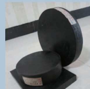
板式橡胶支座（试验研究）
