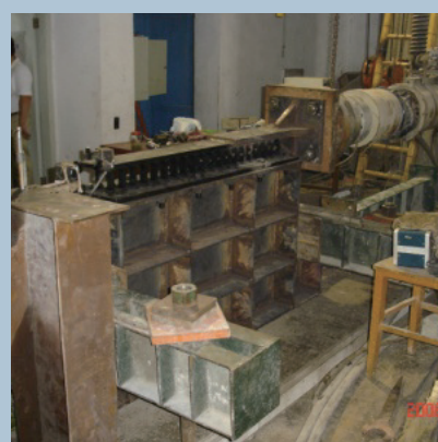
中国移动通信公司上海万荣局抗震加固 (试验研究) 消能减震阻尼器性能试验研究
