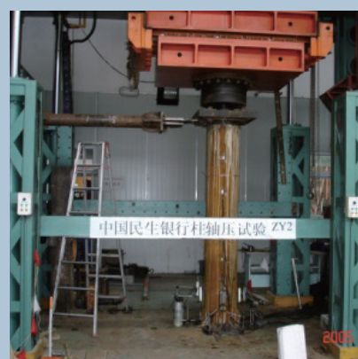
中国民生银行大厦改造（试验研究） 外包钢管加固柱试验研究
