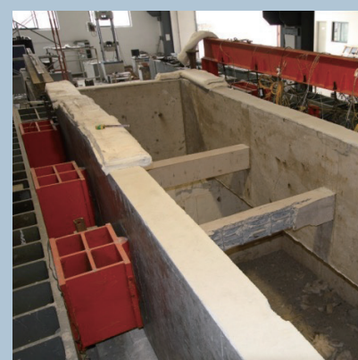
构件耐火性能检测（试验研究）
