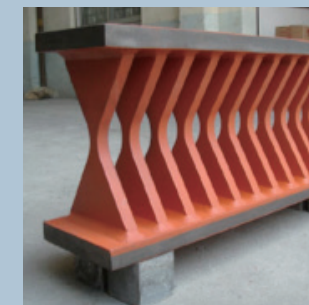
金属屈服型阻尼器（试验研究）
